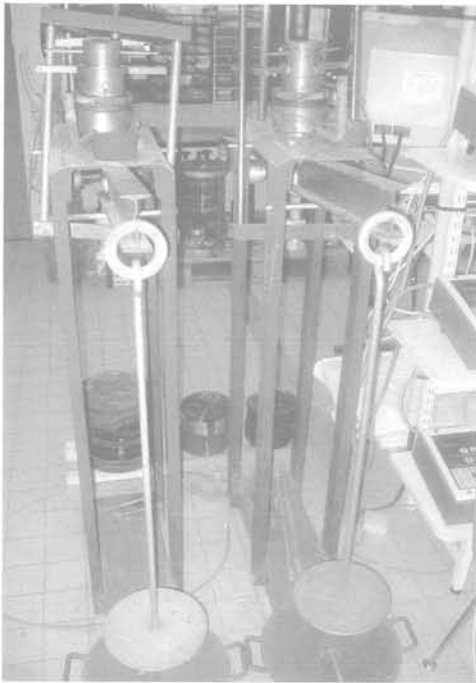
FIG. 19 Œdomètre mécanique. Mechanic oedometer.
