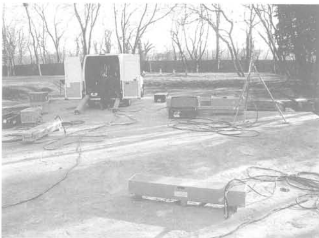
FIG. 9 Dispositif cross hole (avec triplet). Cross hole dispositive.
