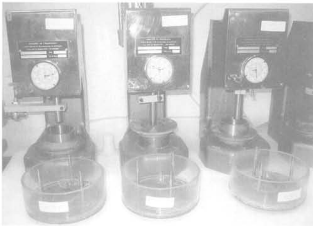
FIG. 20 Œdomètre pneumatique. Pneumatic oedometer.
