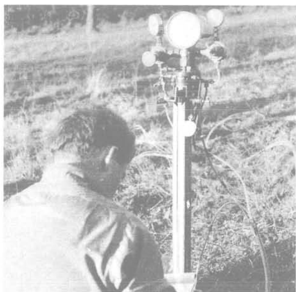
FIG. 22 Matériel pressiométrique élémentaire L. Ménard (1965). Basic pressuremeter apparatus.
