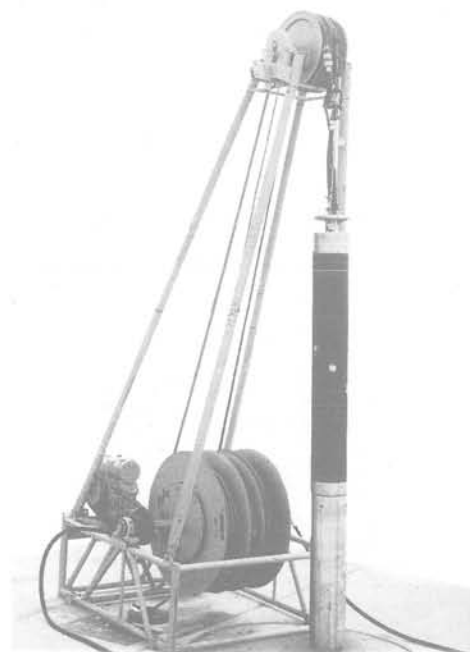
FIG. 3 Dilatomètre (1970). Dilatometer cell.
