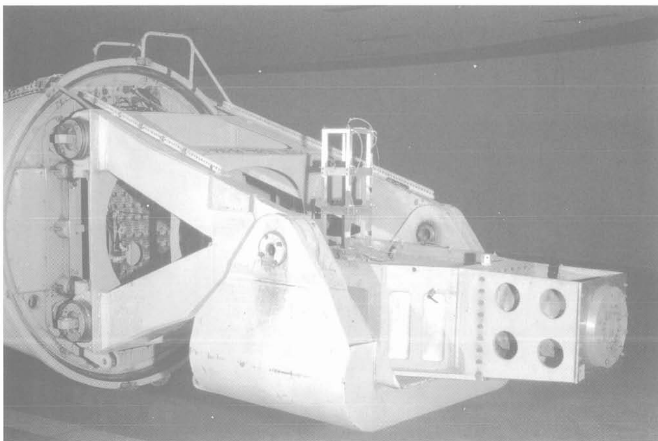
Fig. 2. — Générateur d'onde sismique pour essais en centrifugeuse (CESTA). Fig. 2. — Seismic wave generator for centrifugal testing (CESTA).
