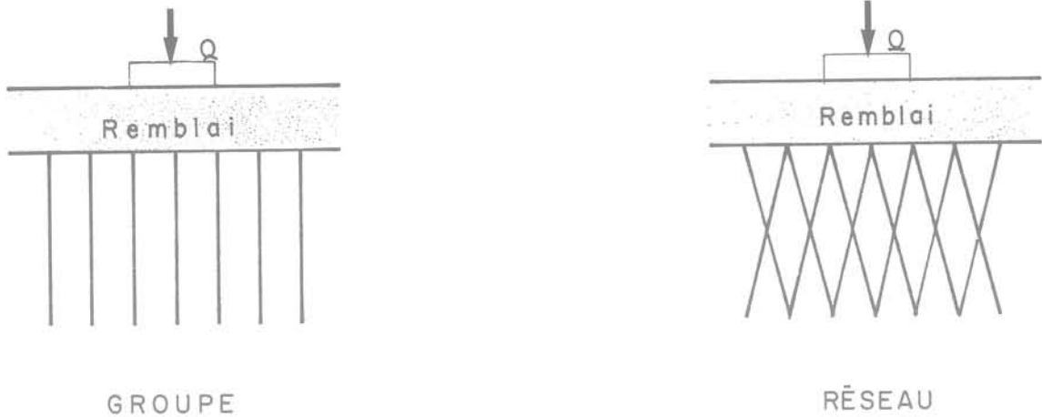
Fig. 1. — Etude expérimentale du renforcement d'un sol lâche par inclusion de micropieux.
