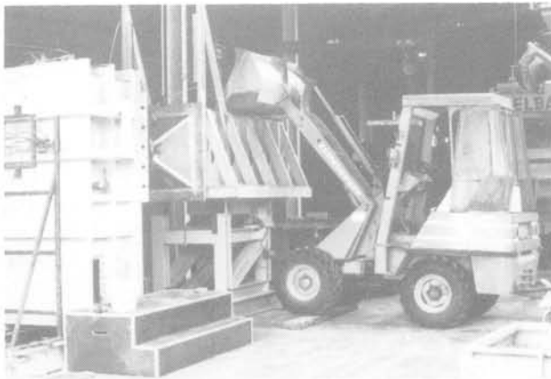
Fig. 7. — Le « gros » appareillage en cours de chargement du terrain à tester.
