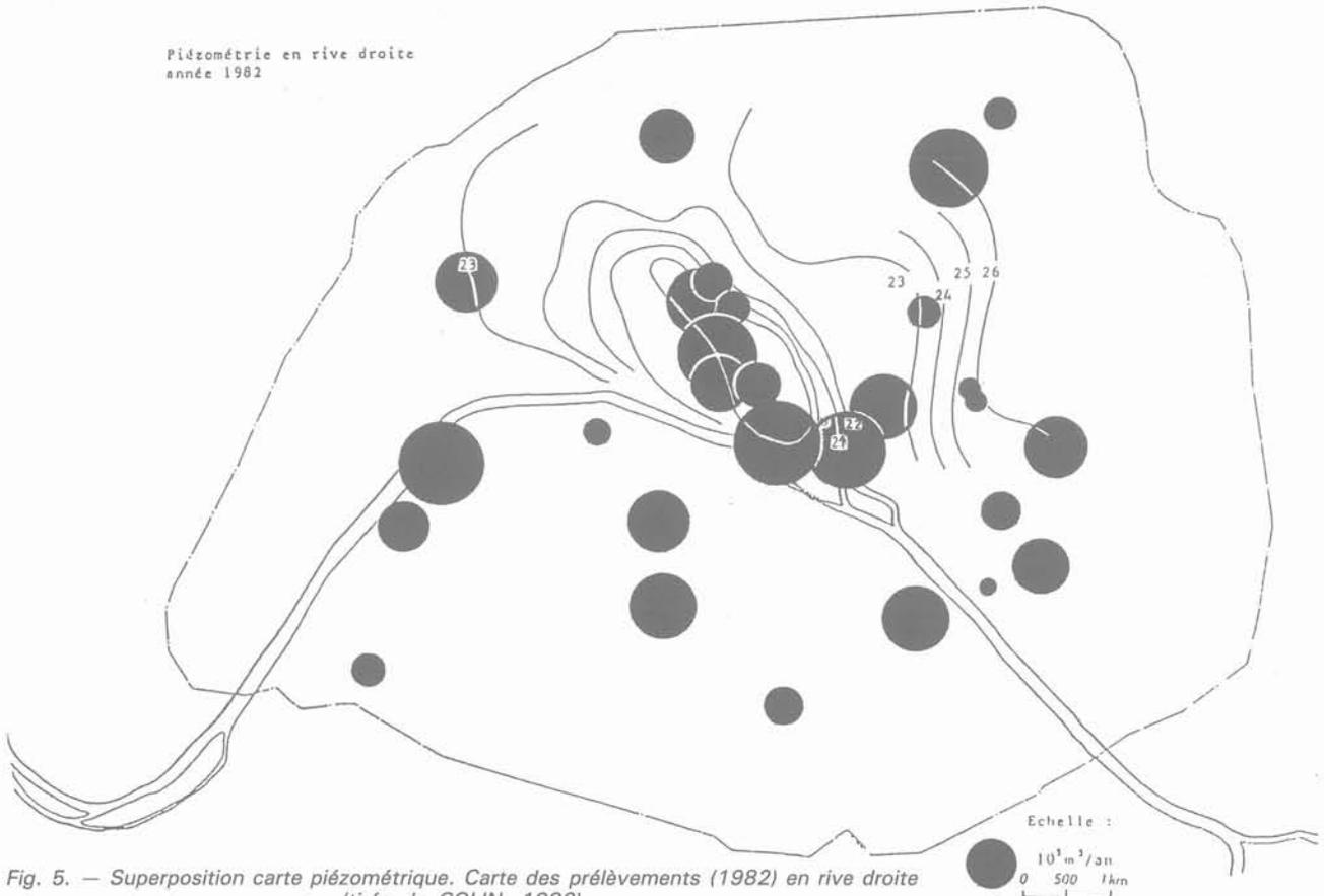
Fig. 5. — Superposition carte piézométrique. Carte des prélèvements (1982) en rive droite (tirée de COLIN, 1986).
