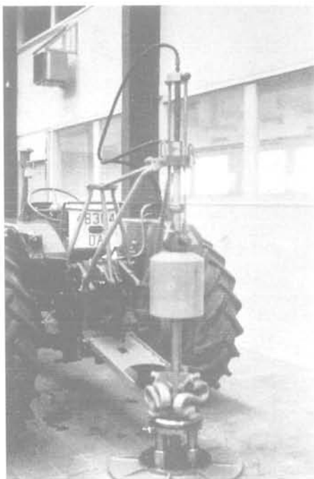
FIG. 13 Déflectomètre à boulet et à « jarret » (1963). Ball deflectorometer with "jarret" self damping springs.
